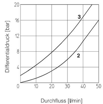
**5 DIAGRAMME VON KG-03\*** (mit Mineralöl ISO VG 46 bei 50°C)
