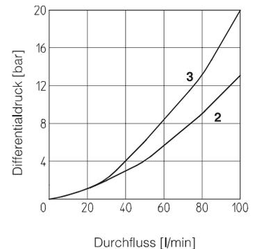
**6 DIAGRAMME JPG-211** (mit Mineralöl ISO VG 46 bei 50°C)
