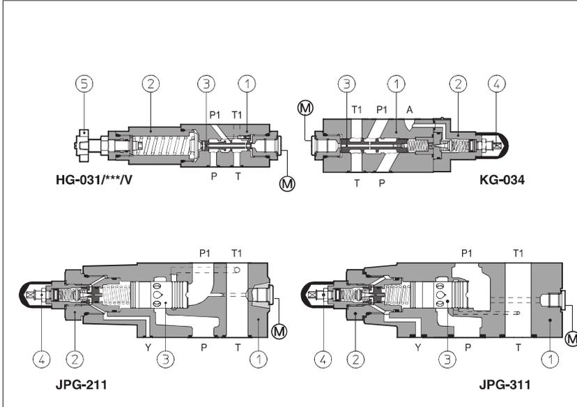
**HG, KG, JPG** sind Druckminderventile, Kolbenausführung ③, geeignet für den Betrieb in hydraulischen Ölsystemen.
