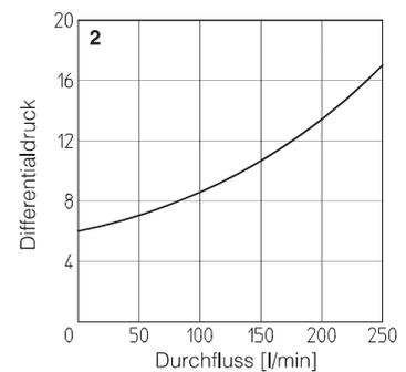
**7 DIAGRAMME JPG-311** (mit Mineralöl ISO VG 46 bei 50°C)
