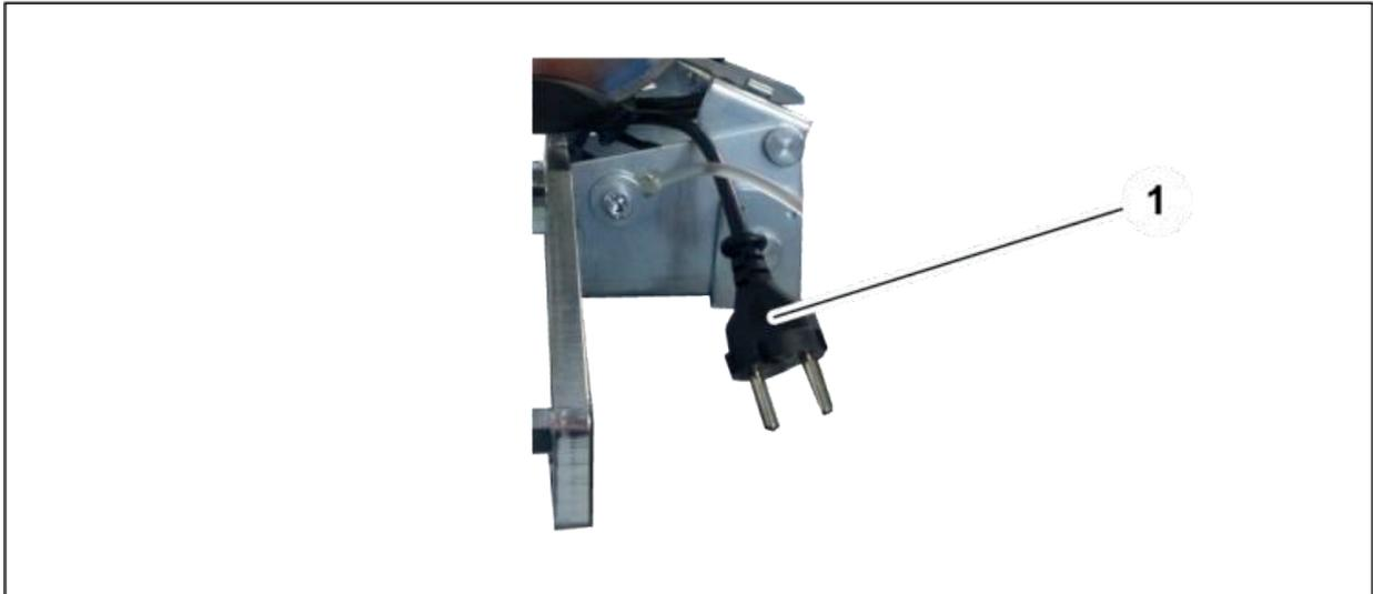
Die Trennmaschine hat einen Gerätestecker Kontur / Schutzklasse 2 (1).
