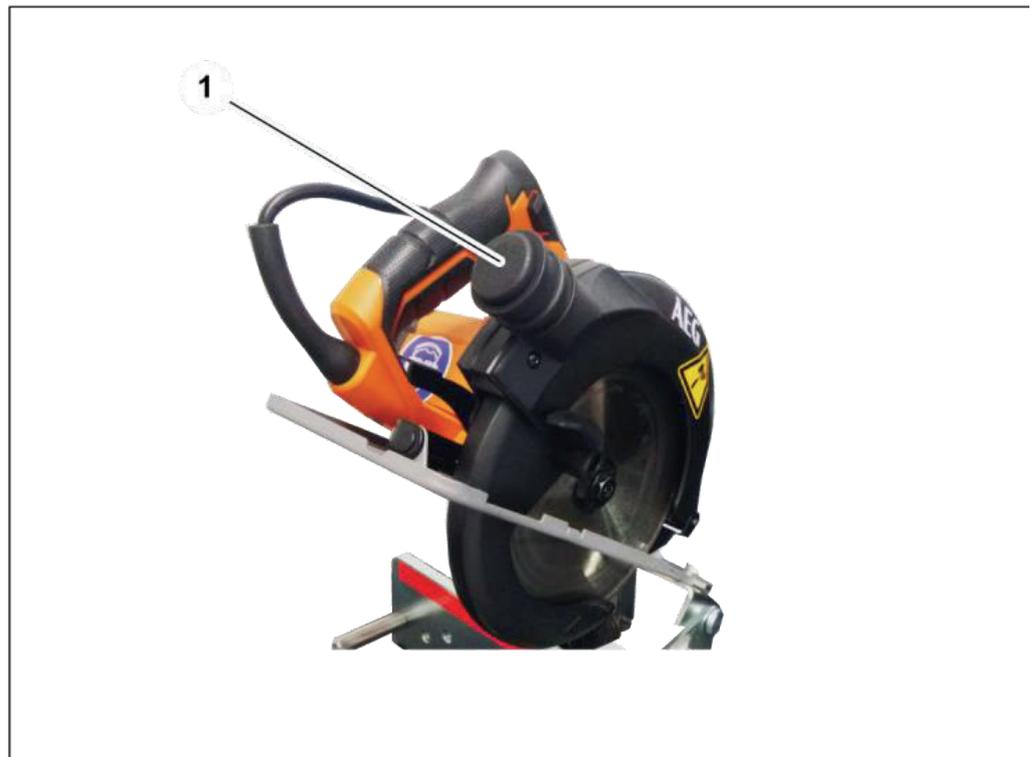
1. Metallschlauch zur Absaugung des Rauches und der Schmutzpartikel an den Absaugstutzen (1) montieren
