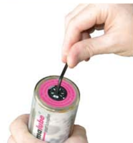
Laufzeit mit 3 mm Innen-sechskantschlüssel aktivieren
