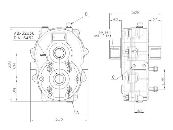
Belüftungbei um 180° gedrehtem Getriebe
