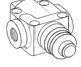
Mechanisch betätigtes Endhubventil mit zwei Stellungen für Kippfahrzeuge (Anhänger). Es stoppt den Durchfluss zum Zylinder, ohne ihn zum Tank zu leiten. Online-Montage (siehe Seite 4). Ausgestattet mit einem eingebauten Rückschlagventil mit Flanschverbindung zum Fahrgestell. Es sind mehrere Modelle mit verschiedenen Durchflussmengen erhältlich
