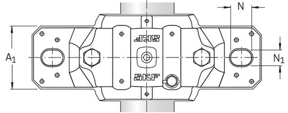
Palier avec un roulement à rotule sur rouleaux étanche
