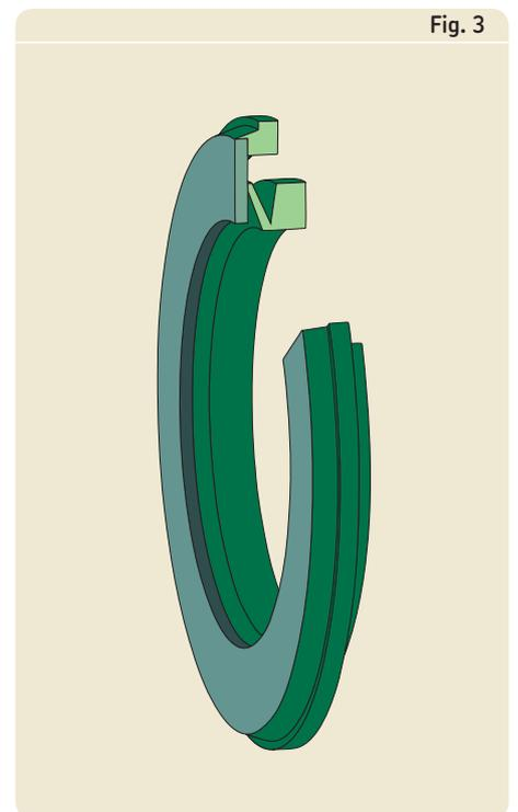
tourne avec l'arbre. Il est efficace dans la plupart des conditions de fonctionnement difficiles telles que des vitesses élevées ou des arbres à fort coefficient de rugosité. Les joints V-ring admettent des vitesses périphériques supérieures à 7 m/s s'ils sont maintenus sur l'arbre par une bague support. Les dimensions recommandées pour les bagues d'appui qui conviennent pour la fixation axiale et radiale sont indiquées dans le **tableau 3**.
