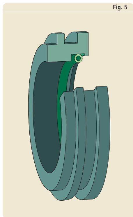
Joint Taconite haute résistance à chicane radiale
