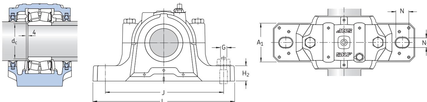
Palier avec un roulement à rotule sur rouleaux étanche
